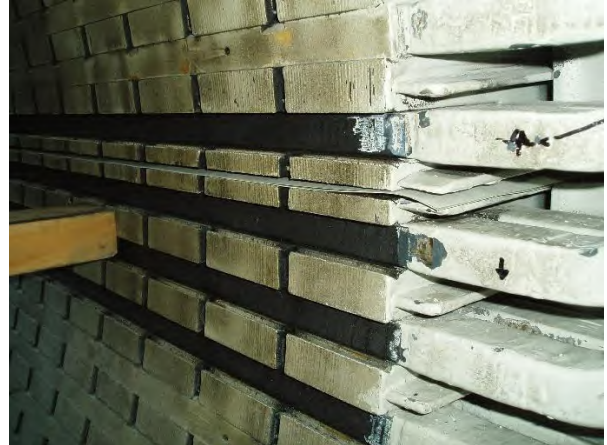
Die Statortrennungsisolation wurde ersetzt.
