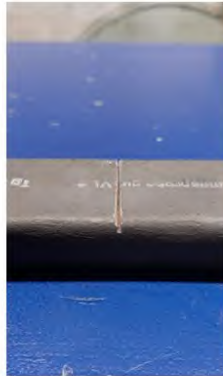
Riss (gesägte Isolierung)
