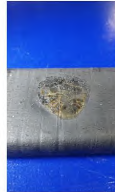
Perforation der Isolierung durch Lichtbögen
