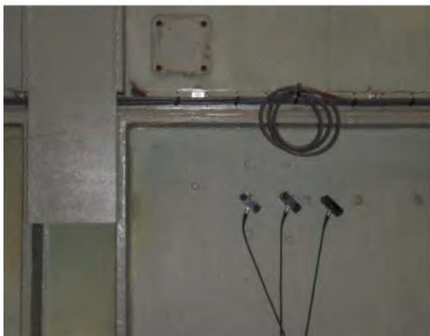
Abbildung 6: Drei akustische Sensoren in einer Reihe – ICMacoustic Triangulations Software
