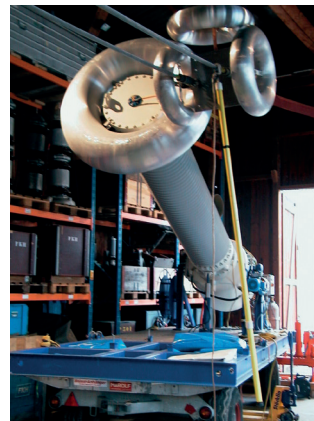
Abbildung 28: Der gasisolierte 400-kV-Prüftransformator der Firma Trench GmbH
