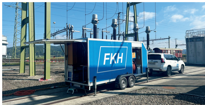
Abbildung 12: Mobile Quelle für die Erzeugung des experimentellen Erdschlussstroms
