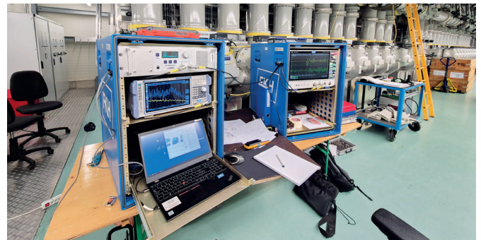
Abbildung 10: UHF-TE-Messplatz mit Multiplexer, Spektrumanalysator und Oszilloskop
