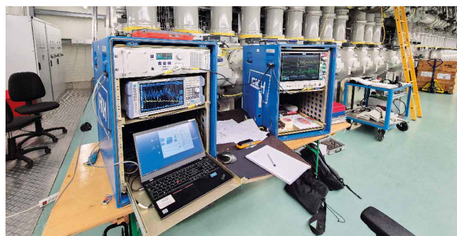
Illustration 10: Poste de mesure des DP en UHF avec multiplexeur, analyseur de spectre et oscilloscope
