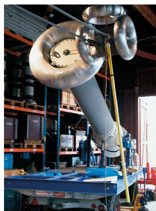
Illustration 28: Le transformateur d'essai de 400 kV à isolation gazeuse de la société Trench GmbH
