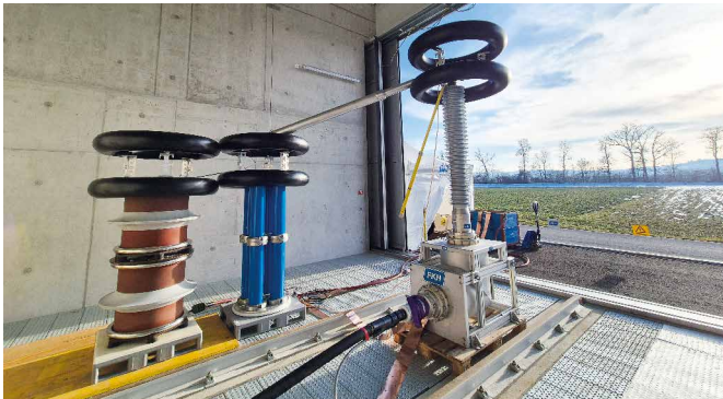
Illustration 7: Installation d'essai haute tension pour un essai sur un PSEM de 145 kV (tension via un câble d'essai Connex de taille 6)
