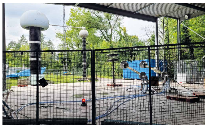
Illustration 30: Zone couverte devant le hall d'essais, avec un montage d'essai pour les essais par paliers, alimenté par le transformateur d'essai de 1 MV (à l'arrière-plan)
