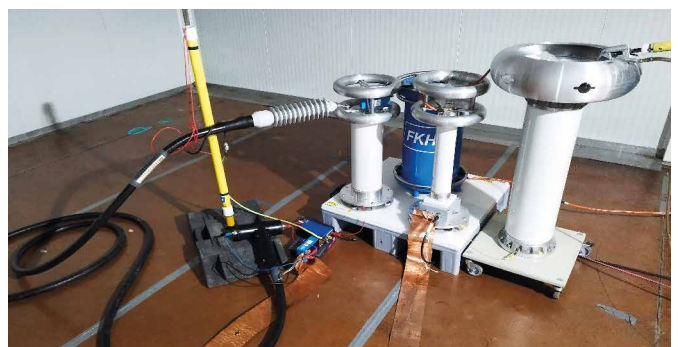
Illustration 26: Contrôle d'un câble d'essai à l'aide d'une installation de résonance série dans le petit laboratoire (de gauche à droite: câble d'essai, condensateur de couplage, inductance de résonance, diviseur de tension et condensateur de charge supplémentaire)
