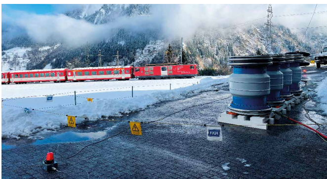
Illustration 1: Essai sur câbles avec inductances de résonance série
