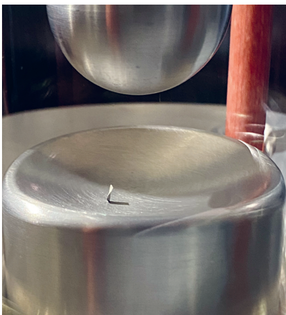
Bild 3 Die Fehlerstelle «frei bewegliches Partikel» ist eine der drei Fehlerstellen der Testzelle.
